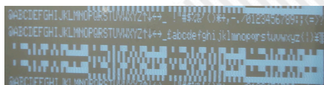
Fig. 3 - I caratteri alfanumerici e semi-grafici di cui era capace il TRS-80 (elaborato da una foto di Kevin Savetz, fonte Wikimedia Commons)
